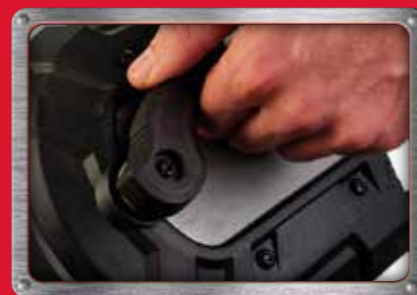
Замена полотна одним нажатием
