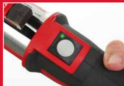
FORCE LOGIC™ индикатор обжатия
