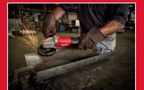
Муфта безопасности защищает пользователя от эффекта "обратного удара"
